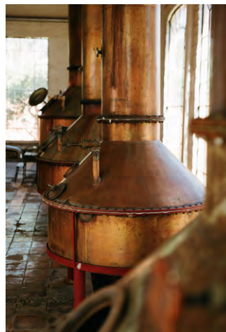
Die Destillation in kupfernen Brennblasen entfernt Verunreinigungen und konzentriert den Alkoholgehalt.
